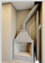
Sistema de exaustão semicoletivo
